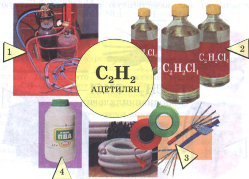
Рис. 24. Применение ацетилена: 1 — резка и сварка металлов; 2—4 — производство органических соединений (растворителей 2, поливинилхлорида 3, клея 4)
